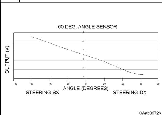
La posizione del sensore è corretta quando la tensione rilevata in uscita dal sensore rientra nel campo indicato:
