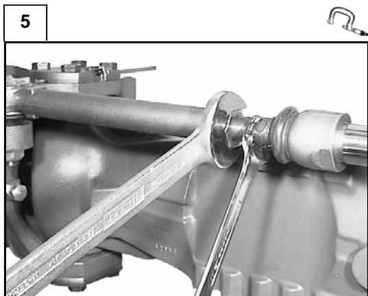
Eseguita la regolazione, avvitare i dadi di bloccaggio (2) delle aste guida (1) alla coppia di serraggio prevista (vedi C.8).
