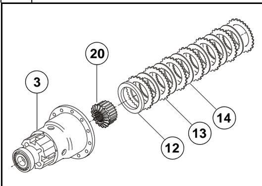
Sfilare dalla scatola differenziale (3): i dischi frizione (14), i controdismi frizione (13), la rondella (12) e l'ingranaggio planetario (20).
