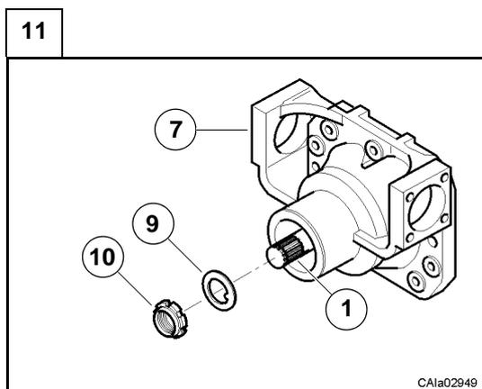
Inserire la rondella fermo ghiera (9) ed avvitare una nuova ghiera di serraggio (10) sul codolo del pignone.
