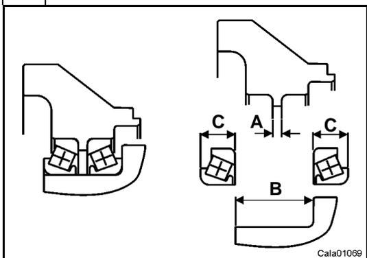
La speciale esecuzione "Set Right" dei cuscinetti (8) e (12) non richiede specifiche registrazioni del precarico o del gioco. In ogni caso, prima del montaggio di nuove parti, controllare le dimensioni indicate.
