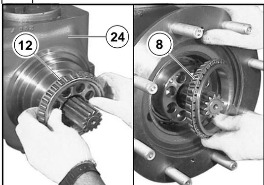
Montare il cono del cuscinetto a rulli conici (12) sul codolo della calotta (24).
