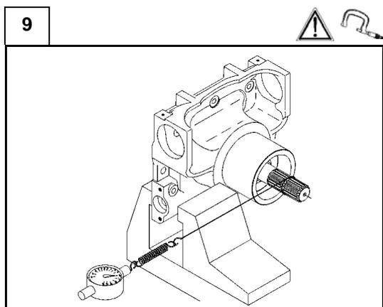
Stabilito il gioco pignone-corona, misurare il precarico totale **T** dei cuscinetti (sistema pignone-corona), utilizzando un dinamometro con la funicella avvolta sul codolo scanalato del pignone. Il valore misurato deve rientrare nel seguente campo:
