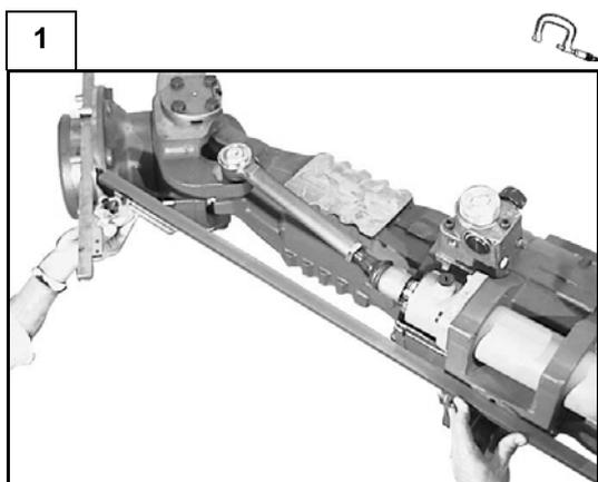
Utilizzare le stesse barre montate per la registrazione della convergenza ed una barra lunga, appoggiata perfettamente alla parte lavorata del corpo centrale (lato pignone), in modo che al massimo della sterzata le due barre formino un angolo acuto.
