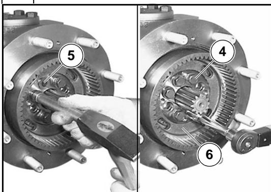
Piantare con il tampone CA715278 ed un martello tutte le bussole (5) di centraggio mozzo fino a battuta.
