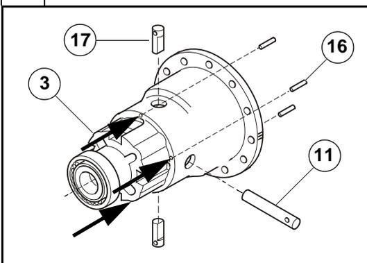
Utilizzando un punzone sottile (cacciaspine), spingere fuori dalle loro sedi le tre spine (16) di bloccaggio per estrarre i perni portasatelliti corti (17) ed il perno portasatelliti lungo (11).
