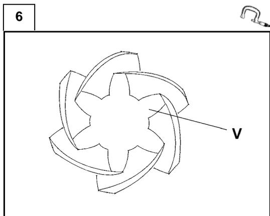
Per determinare il valore (S) dello spessore necessario tra pignone e cuscinetto sottrarre dal valore misurato (X) il valore (V) stampigliato sulla testa del pignone (V=distanza conica prescritta).
