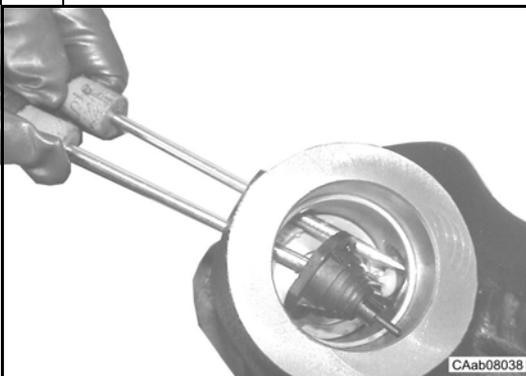
Posizionare la boccia in gomma (12) ed il sensore (10) in sede.
