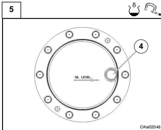
Ruotare il riduttore fino a portare il foro (4) nella posizione indicata.
