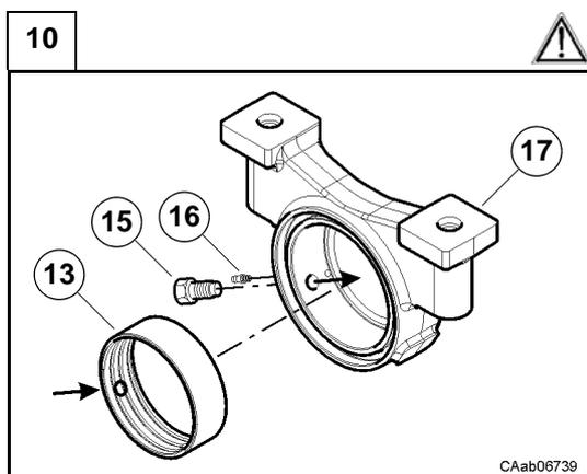
Montare la boccola (13) nel supporto anteriore (17) utilizzando un tampone adatto ed un martello.
