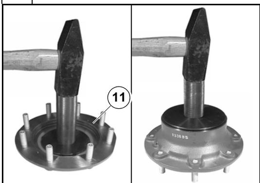
Piantare le coppe dei cuscinetti a rulli conici (8) e (12) sul mozzo ruota (11) utilizzando l'attrezzo speciale CA715277 sotto l'azione di una pressa o di un martello.
