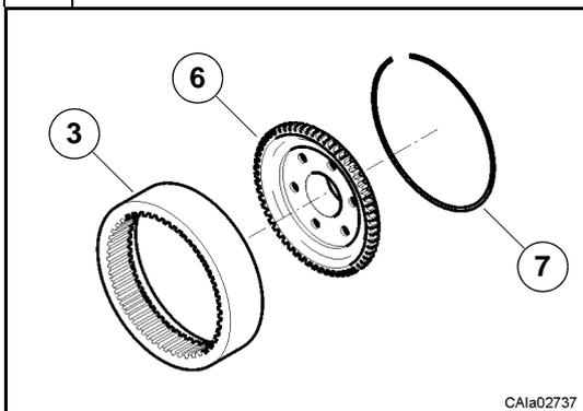
Preassemblare il mozzo porta corona (6) e la corona epicicloidale (3) con lo speciale anello d'arresto (7).
