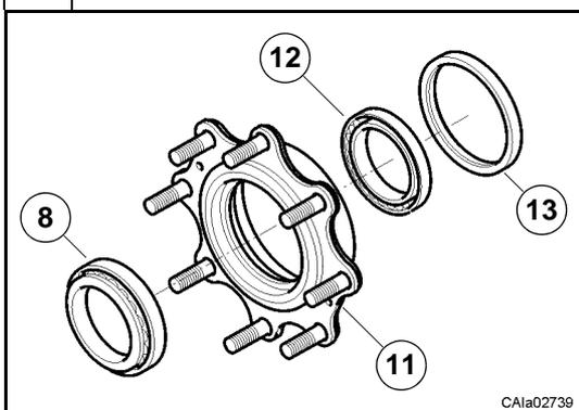
Posizionare su di una superficie piana il mozzo ruota (11) ed estrarre l'anello di tenuta (13) con una leva.
