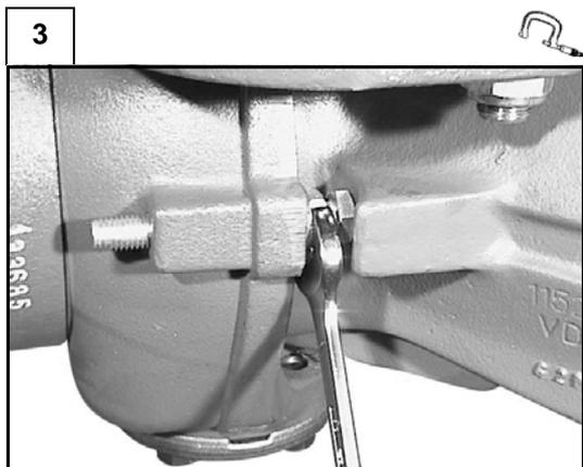
Effettuare la regolazione del fermo meccanico di sterzata, avvitando o svitando l'apposita vite (4), bloccandola poi con il controdado (5) alla coppia di serraggio prescritta (vedi C.8).
