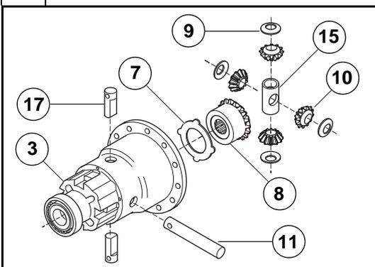
Disassemblare i perni portasatelliti corti (17) ed il perno lungo (11) e recuperare tutti i particolari contenuti nella scatola differenziale (3): crociera (15), ingranaggi satelliti (10), rondelle di rasamento (9), ingranaggio planetario (8), controdisco bloccaggio differenziale (7).
