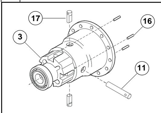
Bloccare i perni portasatelliti corti (17) ed il perno portasatelliti lungo (11) appena assemblati sulla scatola differenziale (3), inserendo nelle sedi le apposite spine di fissaggio (16). Ruotare a mano i perni portasatelliti corti (17) ed il perno portasatelliti lungo (11) per allineare i fori per le spine di fissaggio alle sedi sulla scatola differenziale (3).
