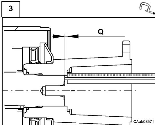
Verificare che la flangia sia ben inserita fino "a battuta" e rilevare la quota indicata **Q** misurata dall'estremità del codolo alla superficie di battuta per la rondella (3).
