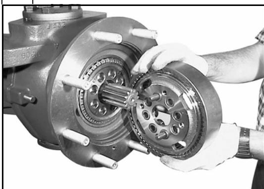
Montare il gruppo mozzo porta corona sul mozzo ruota utilizzando le due bocche sporgenti come spine di centraggio. Avvitare le relative viti (4) fino a portare il gruppo a contatto con il mozzo ruota.
