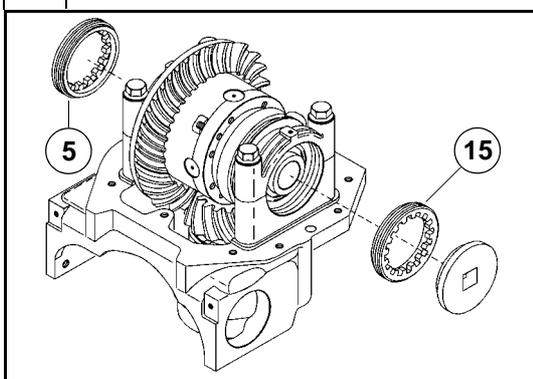
Svitare le ghiera di registro (5) e (15) con la chiave speciale CA715270. **Nota:** le ghiera (5) e (15) sono diverse; annotarne il lato di montaggio rispetto alla corona conica.
