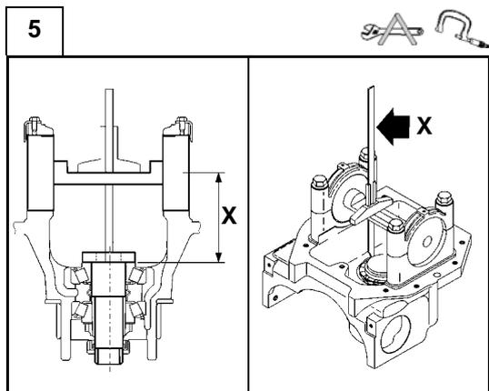
In figura: schema montaggio "falsa scatola differenziale"
