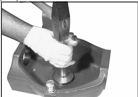
Piantare la bronzina (32) nella calotta (24) con il battitoio CA715423 ed un martello o una pressa.
