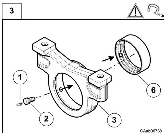
Montare la boccia (6) nel supporto posteriore (3).
