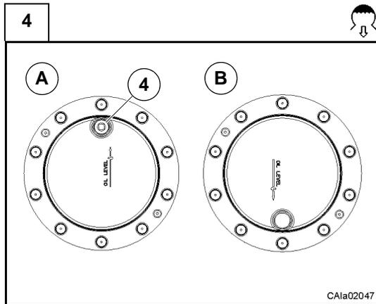
**Attenzione:** eseguire tutte le operazioni di scarico, carico e verifica livello olio con l'assale orizzontale.
