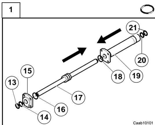
Montare nuovi anelli di tenuta ed OR (13, 14, 16, 18, 20 e 21) sulla testata (15), sul pistone dello stelo (17) e nel corpo cilindro (19).
