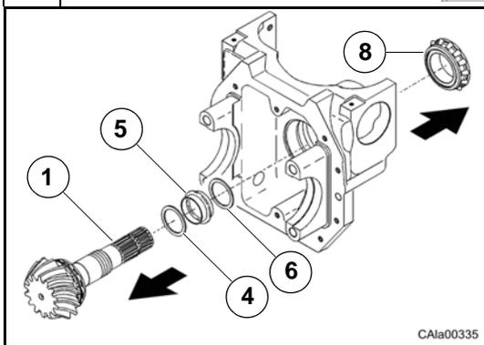
Battere con un martello di materiale tenero sul codolo per sfilare il pignone conico (1).
