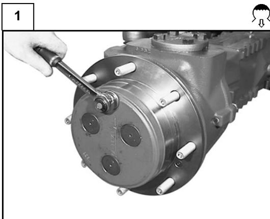
Scaricare completamente l'olio dal riduttore epicicloidale.
