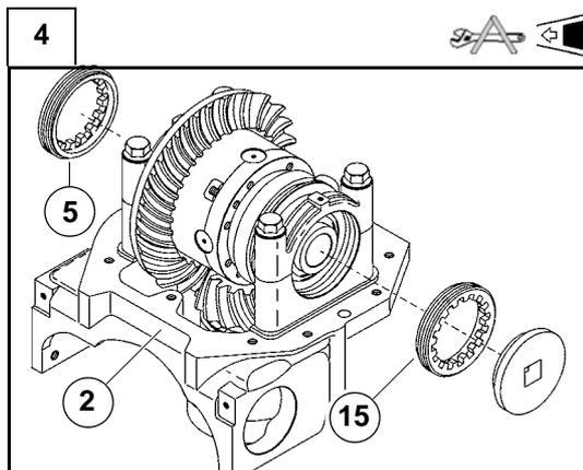
Montare ed avvitare le ghiera di registrazione (5) e (15) nel supporto differenziale (2) con la chiave speciale CA715270 fino ad eliminare il gioco e precaricare leggermente i cuscinetti del differenziale.
