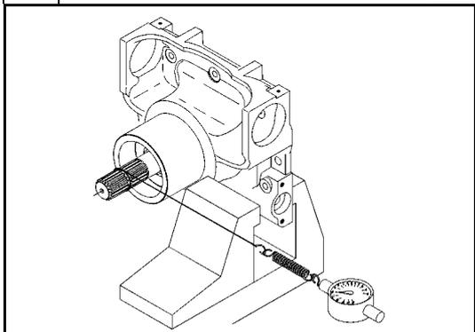
Effettuare la misurazione del precarico **P** dei cuscinetti conici (3) e (8), utilizzando un dinamometro con la cordicella, avvolta sul codolo scanalato del pignone (1).
