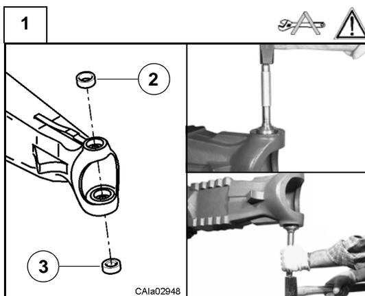
Raffreddare la boccia superiore (2) e la coppa (3) a temperature inferiori a -100 °C con azoto liquido.
