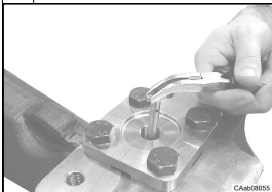
Montare il perno sensore (4).
