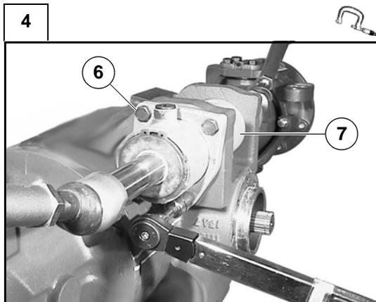
Installare sul corpo centrale il martinetto (7) così assemblato.
