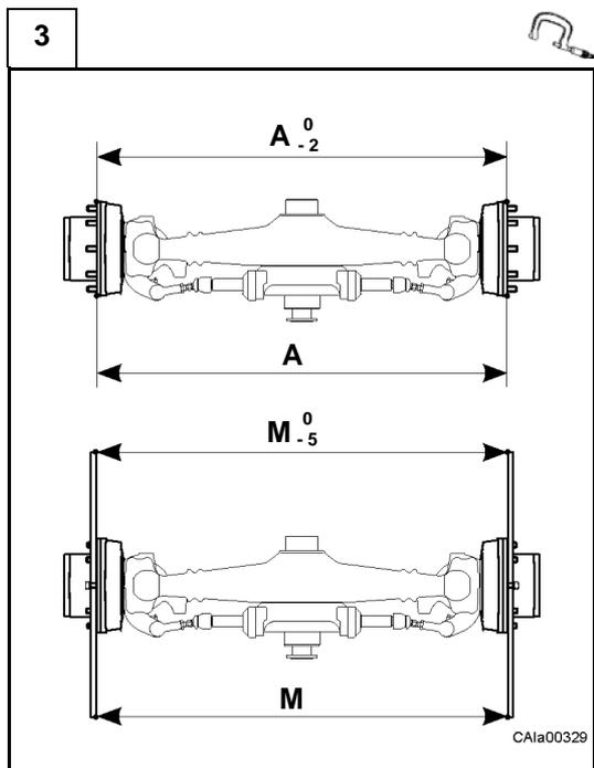
Verificare che la differenza tra le misurazioni alle estremità dei diametri dei mozzi ruota rientri nel campo di tolleranza richiesto.
