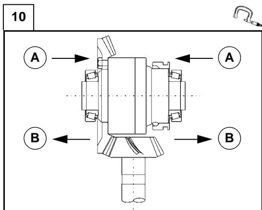
Se la misurazione non rientrasse nel campo prescritto, controllare bene l'assemblaggio di ogni singolo componente ed intervenire sulle ghiera di registrazione (5) e (15) del supporto differenziale (2):
