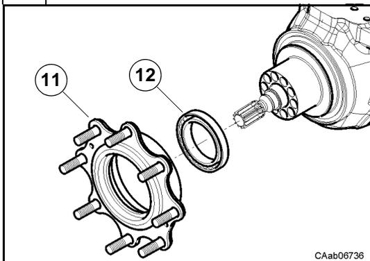
Sfilare il mozzo ruota (11) facilitando lo smontaggio con leve e martello. Togliere il cono del cuscinetto (12) dal codolo della calotta (24) utilizzando un estrattore da commercio.
