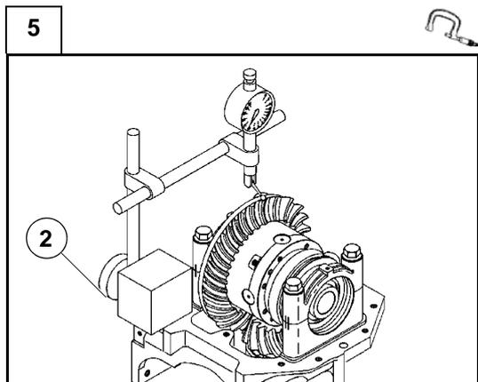
Posizionare un comparatore con base magnetica sul supporto differenziale (2), in modo che il tastatore sia a contatto e a 90° con la superficie di un dente della corona conica.
