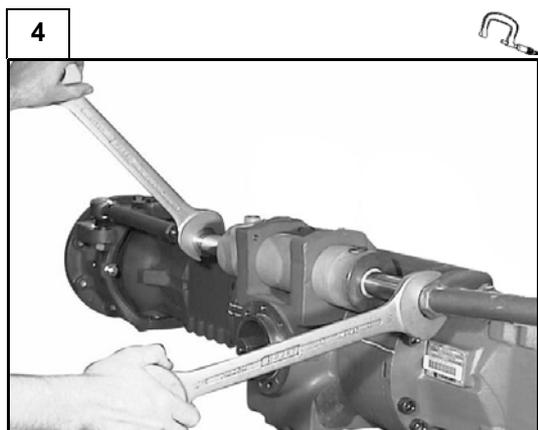
Nel caso che la convergenza non sia esatta agire con due chiavi sulle aste guida (1) avvitando e svitando i due tiranti snodo (3) equamente, in modo che alla fine rientri nella tolleranza prevista.
