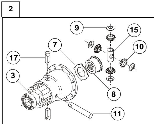
Posizionare la scatola differenziale (3) su di un banco di lavoro ed assemblare con attenzione i suoi elementi: crociera (15), ingranaggi satelliti (10), rondelle di rasamento (9), ingranaggio planetario (8), controdisco bloccaggio differenziale (7), come in figura.
