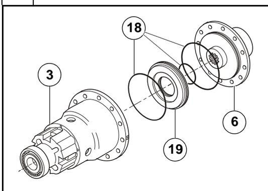
Montare nelle rispettive sedi sul pistone bloccaggio differenziale (19) e sul coperchio differenziale (6) nuovi anelli OR (18) ben lubrificati. Inserire il pistone bloccaggio differenziale (19) ed assemblare il coperchio differenziale (6) alla scatola differenziale (3).
