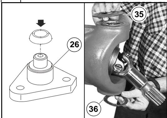
Se precedentemente rimosso il cono dello snodo sferico, riassemblelo sul perno snodo inferiore (26) con l'attrezzo CA715035 sotto l'azione di una pressa
