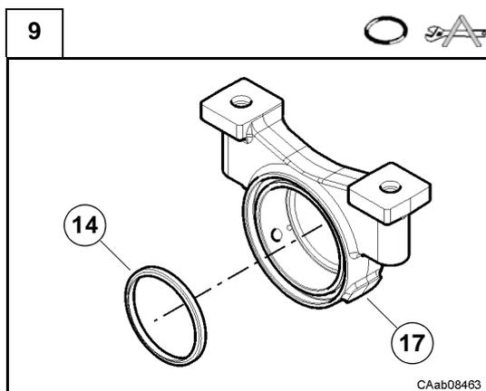
Montare l'anello di tenuta (14) con il tampone CA715032 e lubrificarlo (vedi C.6).
