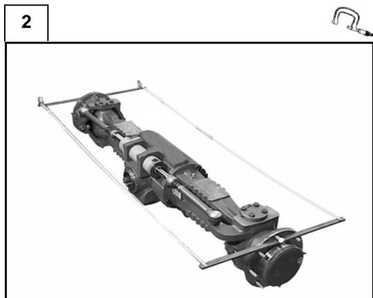
Rilevare con un metro a nastro, dai punti più estremi delle barre, la distanza millimetrica **M**.
