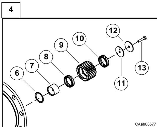
Per sostituire gli ingranaggi (9):
