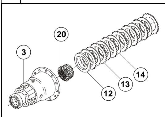
Inserire nella scatola differenziale (3): l'ingranaggio planetario (20), la rondella (12), i dischi frizione (14) ed i controdischi frizione (13) come in figura.
