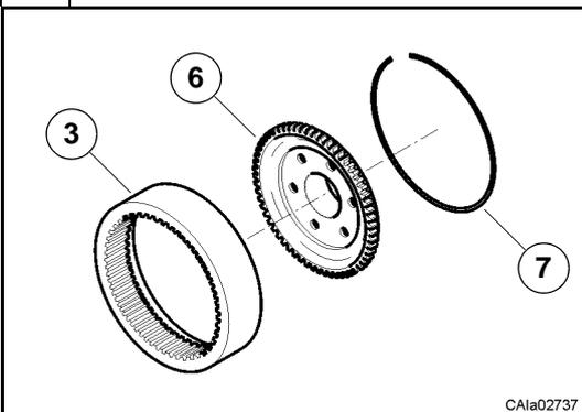
Rimuovere l'anello di arresto d'acciaio (9) e separare il mozzo porta corona (6) dalla corona epicicloidale (3).
