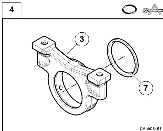
Montare l'anello di tenuta (7) con il tampone CA715460 e lubrificarlo (vedi C.6).
