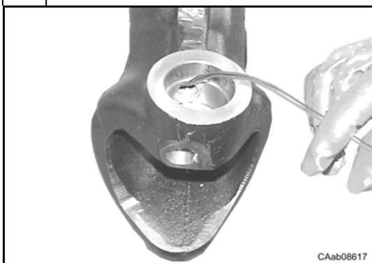
Sfilare i cavi del sensore (13) e recuperare la boccia in gomma (12).
