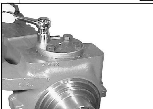
Svitare e togliere le viti di fissaggio (18) e (27) del perno snodo superiore (19) ed inferiore (26).
