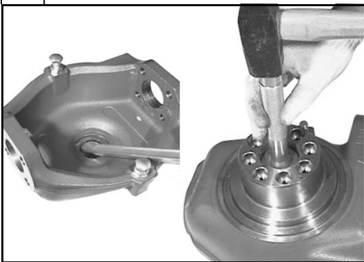
Posizionare la calotta (24) su di una superficie piana ed estrarre l'anello di tenuta (31) con una leva.
