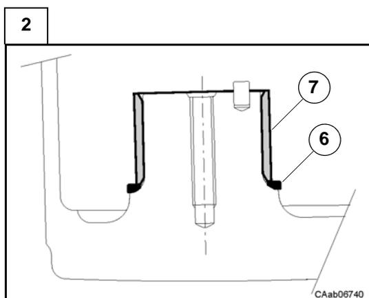
Posizione di assemblaggio della ralla (6) e della boccia (7)
