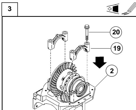
Montare la scatola differenziale completa sul supporto differenziale (2). **Attenzione:** verificare il giusto lato di montaggio della corona conica. Spostare la scatola differenziale in modo da appoggiare la corona conica al pignone.
