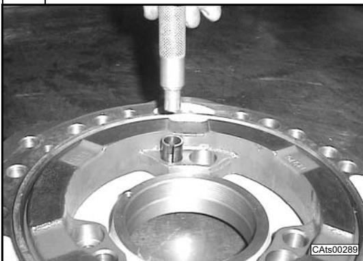
Montare la spina elastica del kit self-adjust nel pistone freno utilizzando il battitoio CA715033.
