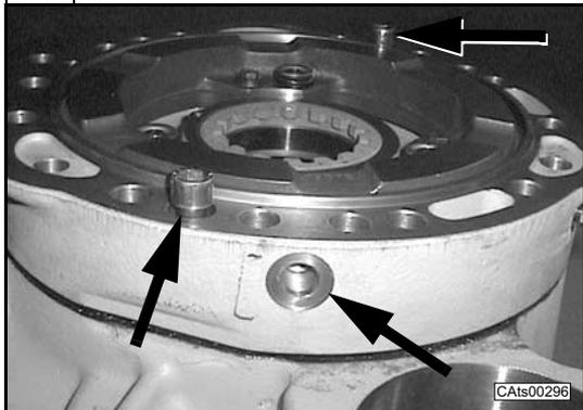
**Attenzione:** controllare il corretto montaggio; il foro connessione olio freni deve essere posizionato verso il lato pignone.
