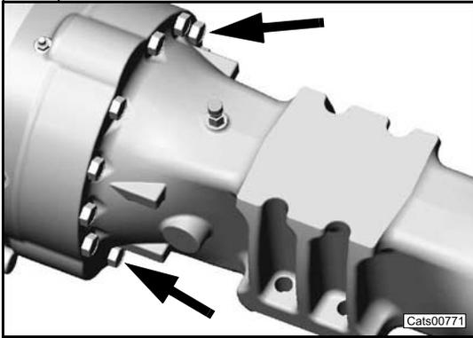
Montare la tromba sulla flangia, facendo attenzione all'allineamento della spina di centraggio.
