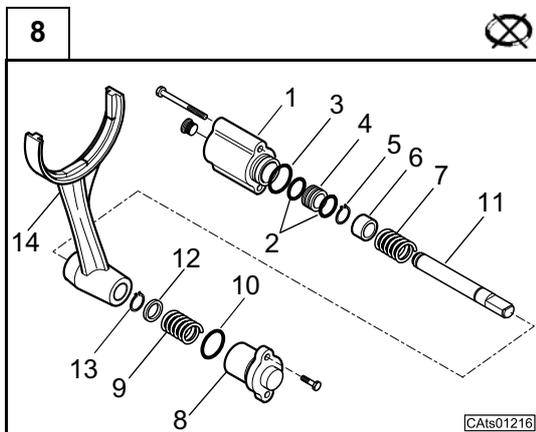
Per rimuovere il dispositivo di bloccaggio differenziale, svitare le viti del supporto cilindro (1), quindi sfilarlo recuperando gli anelli OR (2 e 3) ed il pistone (4).
