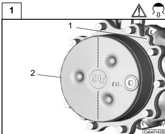
Scaricare completamente l'olio dal riduttore epicicloidale.
