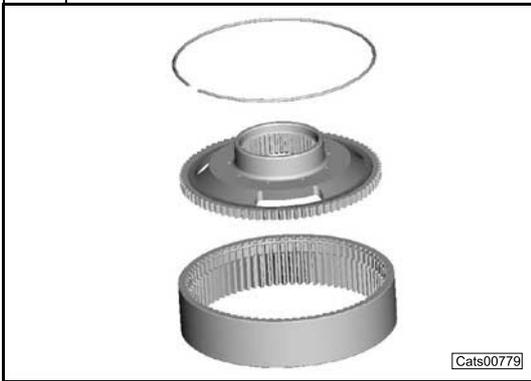
Preassemblare il gruppo mozzo fermo corona - corona epicicloidale con lo speciale anello d'arresto indicato in figura.
