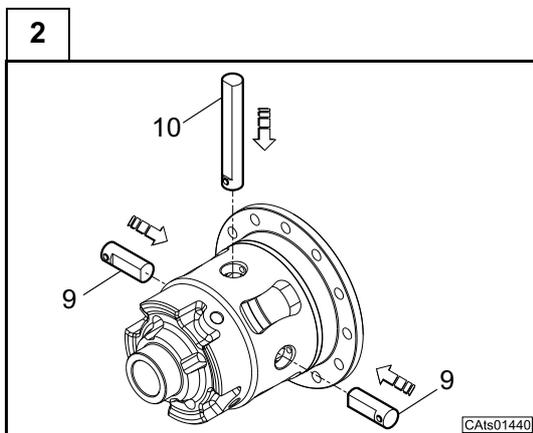
Inserire i perni portasatelliti corti (9) ed il perno lungo (10) nelle appropriate sedi vincolando correttamente gli ingranaggi satelliti (7) e la crociera (6).
