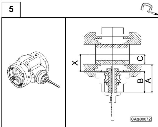
Per registrare la coppia conica misurare con un calibro la distanza "A". Determinare il valore "X" come segue:
