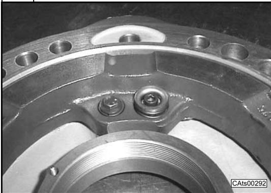
Avvitare le viti di fissaggio dei due kit e serrarle alla coppia di serraggio prevista (Sez. C.6).
