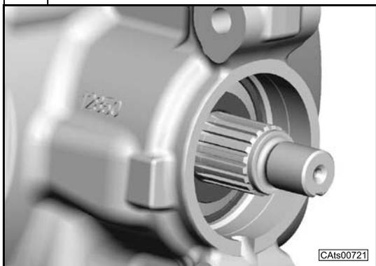
Battere con un martello di materiale tenero sul codolo per sfilare il pignone conico.
