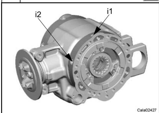
**Attenzione:** nel caso si sostituiscano solo i dischi freno, rimuovere attacchi, sfiatatoi ed eventuali tappi dagli ingressi olio freni (i1) e (i2), (6 e 7 in sezione C.5).
