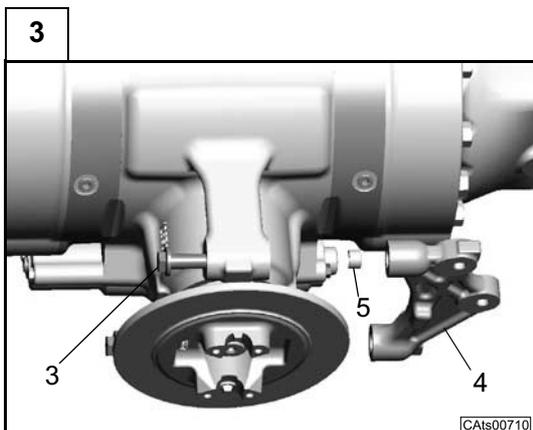
Svitare e togliere le viti (3) di fissaggio del supporto pinza freno.
