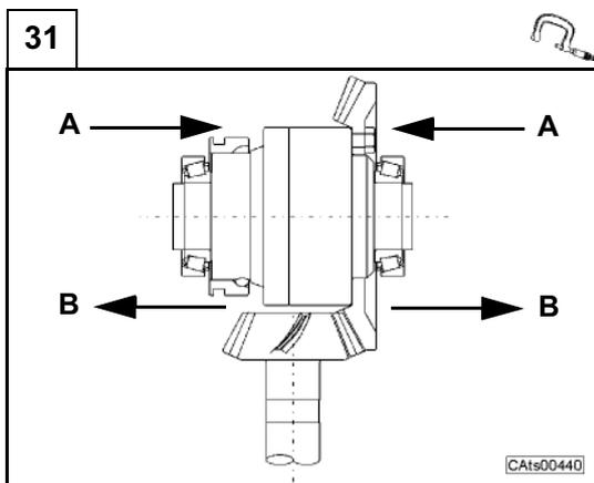
Se la misurazione non rientrasse nel campo prescritto, controllare bene l'assemblaggio di ogni singolo componente ed intervenire sulle ghiere di registrazione del supporto differenziale:
