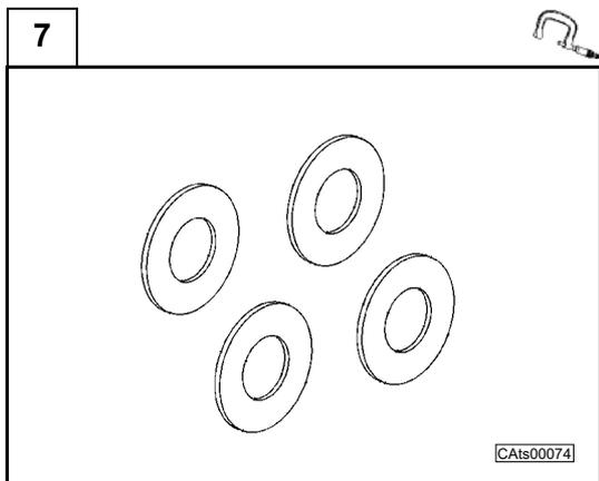
Scegliere lo spessore di valore (S) tra la gamma di spessori a disposizione ed inserirlo sul codolo sotto la testa del pignone.
