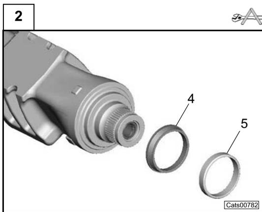
Montare il cono del cuscinetto (4) sul codolo della tromba trave con il battitoio CA715427 ed un martello.
