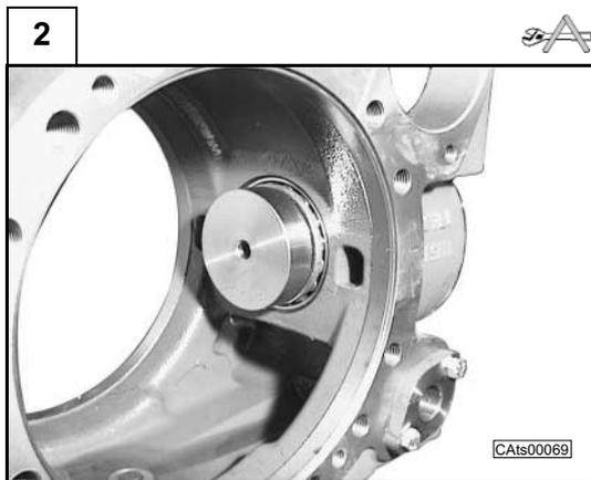
Utilizzare le due attrezzature kit falso pignone CA715519 e falsa scatola differenziale CA119144 per rilevare la distanza conica.
