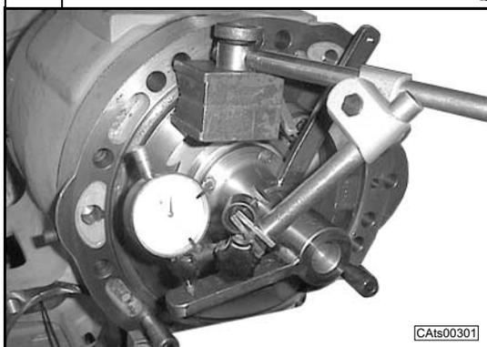
Muovere manualmente e alternativamente la staffa dell'attrezzatura CA715456 montata sul foro della scatola differenziale.
