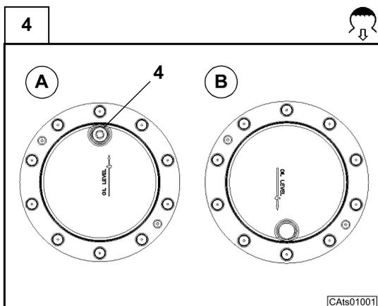
Prima di scaricare l'olio dal riduttore epicicloidale, ruotarlo in modo da portare il tappo olio (4) nel punto più alto [posizione A].
