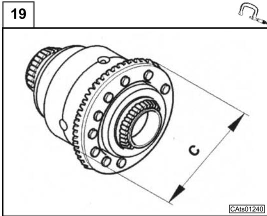
Misurare il diametro esterno **C** della corona dentata montata sulla scatola differenziale.
