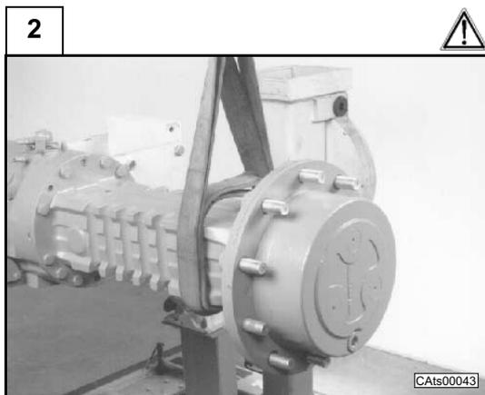
Disporre l'assale su supporti adatti a sostenere sia il corpo centrale che le due trombe, anche dopo la loro separazione, o assicurare i tre gruppi separatamente con funi o cinghie ad un sistema di sollevamento.
