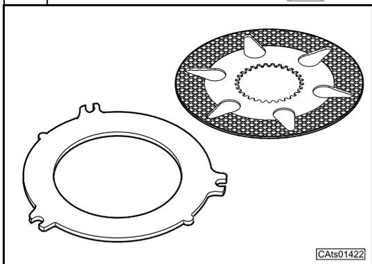
Verificare che i dischi di attrito ed i controdischi non presentino tracce di bruciatura; in caso contrario sostituirli. Verificare inoltre l'usura dei dischi di attrito (Sez. C.4) e sostituirli se necessario.
