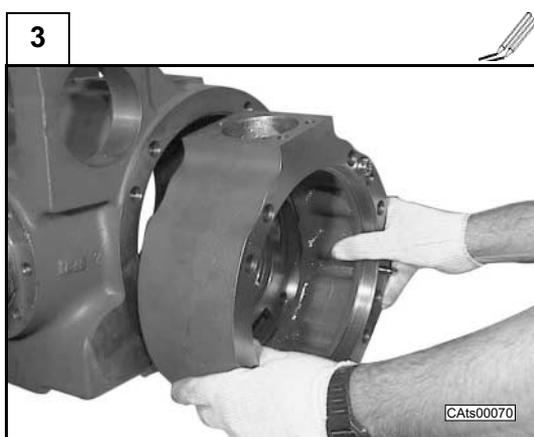
Verificare il corretto posizionamento delle flange destra e sinistra utilizzando i riferimenti riportati sulle medesime e sul corpo centrale.
