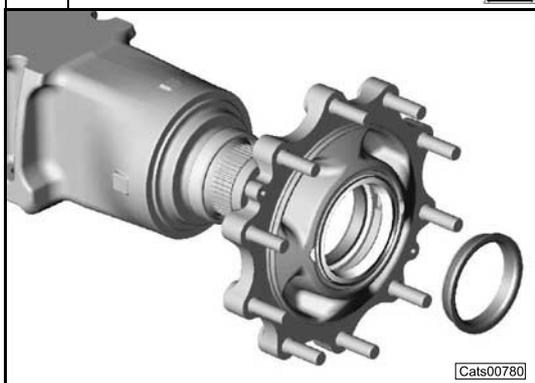
Sfilare il mozzo ruota facilitando lo smontaggio con leve e martello.
