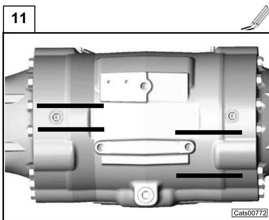
Prima del montaggio, verificare i segni di riferimento eseguiti in fase di smontaggio per il corretto posizionamento delle trombe trave.
