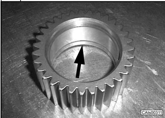
Posizionare su un banco di lavoro i satelliti epicycloidali. Inserire il primo anello d'arresto e la ralla di rasamento.
