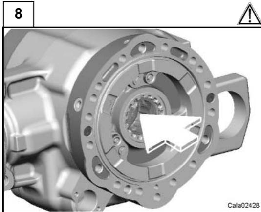
Spingere il pistone del freno in battuta utilizzando il tampone speciale CA715434 con il manico intercambiabile CA119033 ed un martello.
