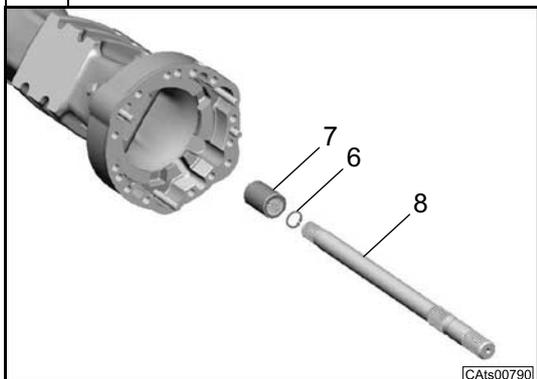
Verificare che l'anello d'arresto (6) sia montato nel manicotto scanalato (7).
