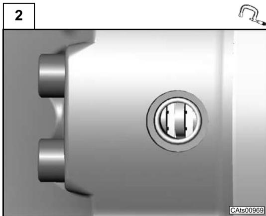
Verificare lo stato di usura del materiale d'attrito dei dischi freno tentando di inserire tra i controdischi una spina di diametro 3,28 mm. Se la spina non entra, i dischi freno sono da sostituire in quanto usurati (Sez. C.4).
