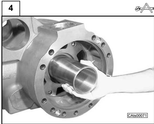
Introdurre nel corpo centrale la falsa scatola differenziale CA119144. Verificare che la falsa scatola sia inserita in entrambe le sedi delle flange freno.
