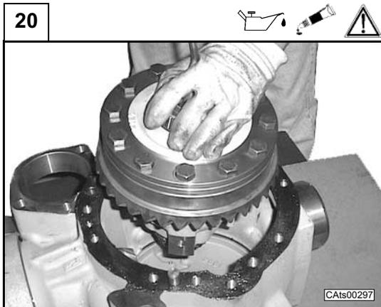
**Attenzione:** verificare sempre il corretto lato di assemblaggio della scatola differenziale. Capovolgere e posizionare il gruppo corpo centrale su una superficie piana.
