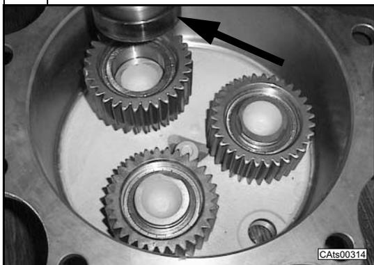
Montare il satellite completo dei suoi componenti nel treno portasatelliti utilizzando l'attrezzo speciale CA715420.
