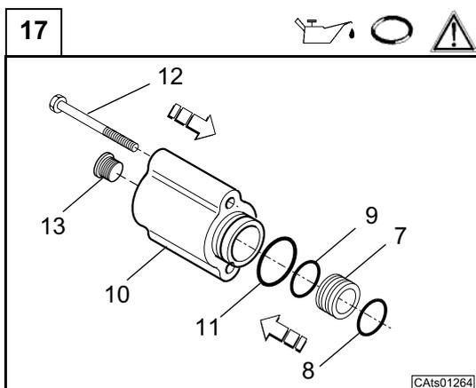
Inserire il pistone (7), con nuovi anelli OR (8) ed (9), nel cilindro (10). Montare sul supporto cilindro (10) un OR (11) nuovo ed inserire il supporto, completo di pistone, sul corpo centrale, fissandolo con le relative viti (12) serrate alla coppia prevista.
