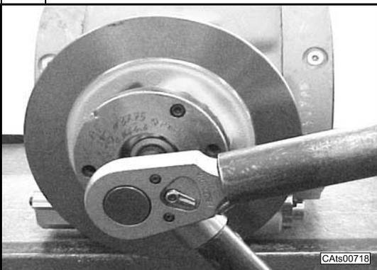
Svitare il dado di bloccaggio pignone con chiave da commercio. Bloccare la rotazione della flangia con l'attrezzatura CA715520.
