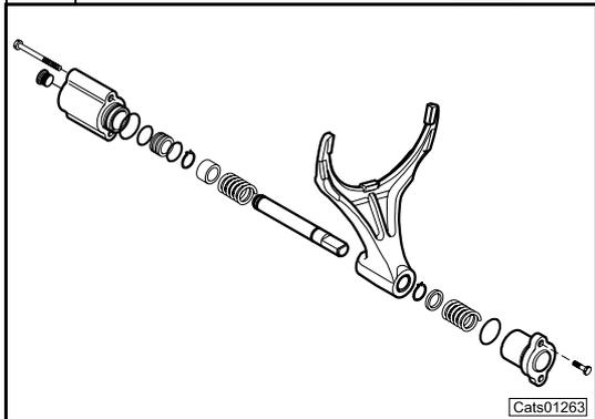
Gli elementi del dispositivo di bloccaggio differenziale devono essere assemblati rispettando le posizioni relative indicate in figura.
