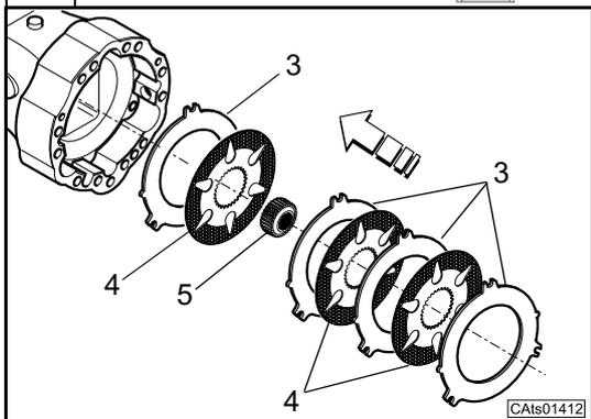
Rimontare tutti gli elementi del gruppo freno all'interno della tromba trave come indicato in figura rispettando la sequenza: controdisco (3), disco freno (4) mozzo traino dischi freno (5) ed i restanti dischi (4) e controdischi (3).
