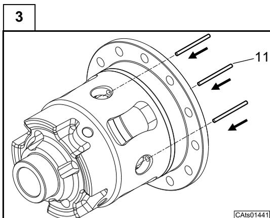
Bloccare i perni portasatelliti corti (9) ed il perno portasatelliti lungo (10) appena assemblati sulla scatola differenziale, inserendo nelle sedi le apposite spine di fissaggio (11). Ruotare a mano i perni portasatelliti corti (9) ed il perno portasatelliti lungo (10) per allineare i fori per le spine di fissaggio alle sedi sulla scatola differenziale.
