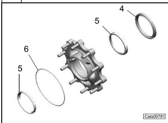
Posizionare su di una superficie piana il mozzo ruota ed estrarre l'anello di tenuta (4) con una leva.
