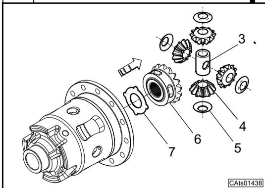
Recuperare tutti i particolari contenuti nella scatola differenziale: crociera (3), ingranaggi satelliti (4), rondelle di rasamento (5), l'ingranaggio planetario (6) e rondella di rasamento (7).
