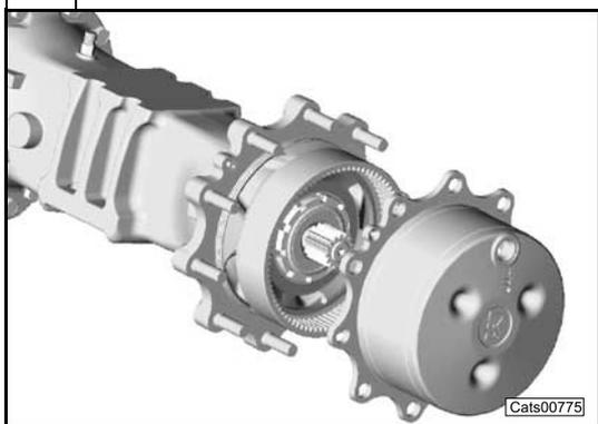
Montare il gruppo riduttore epicicloidale sul mozzo ruota.
