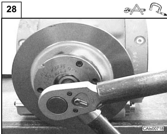
Montare l'attrezzatura CA715520 sui fori filettati della flangia e serrarla con viti TE 5/16" - 24 UNF 2B.
