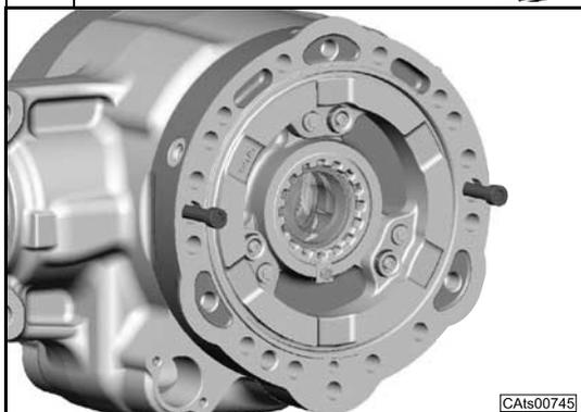
Montare e serrare le due viti di servizio di fissaggio della flangia freno destra sul corpo centrale alla coppia di serraggio prevista (Sez. C.6). Verificare che i segni di riferimento fatti nello smontaggio tra corpo centrale e flangia coincidano.
