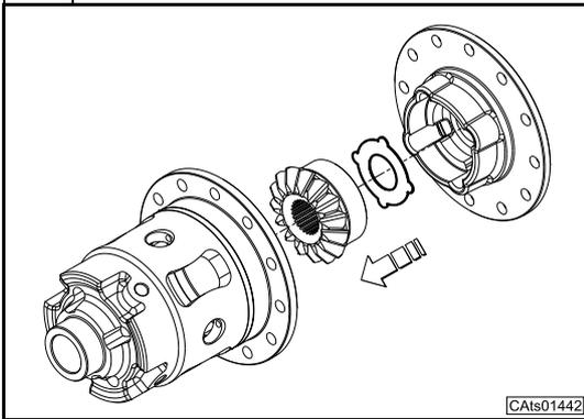
Inserire l'ingranaggio planetario e la rondella di rasamento.
