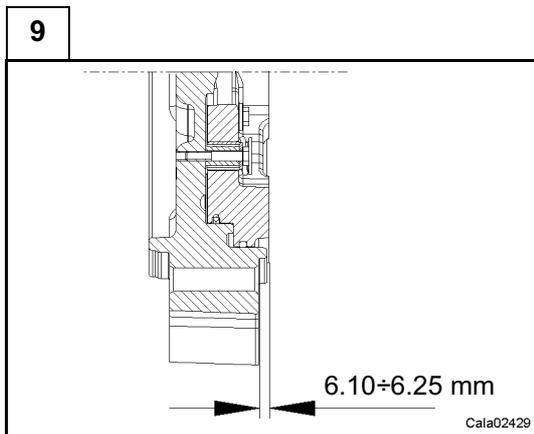
Verificare la quota indicata dalla superficie del pistone alla superficie del cilindro freno.
