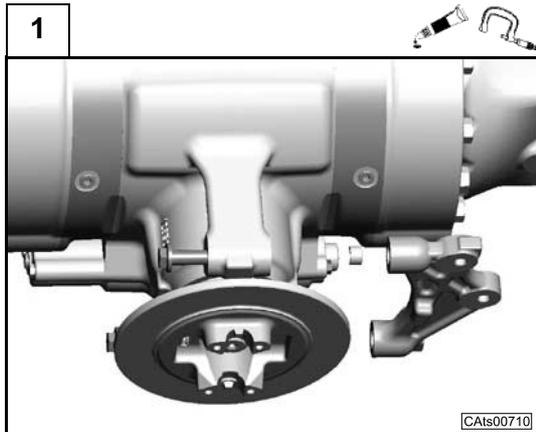
Posizionare il supporto pinza freno centrandolo in sede tramite le bussole di centraggio.
