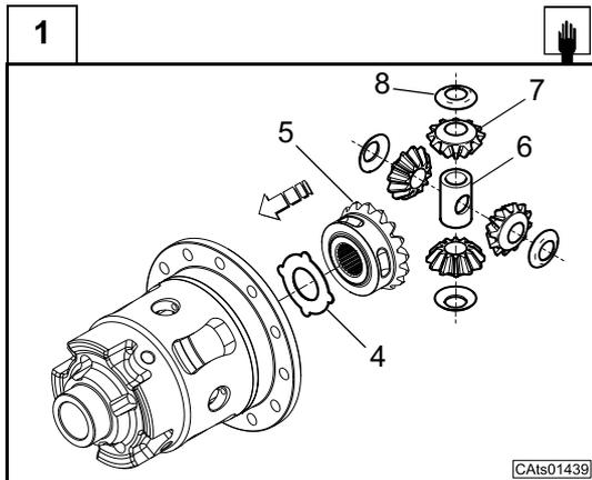
Posizionare la scatola differenziale su di un banco di lavoro ed assemblare con attenzione i suoi elementi: rondella di rasamento (4), ingranaggio planetario (5), crociera (6), ingranaggi satelliti (7) e rondelle di rasamento (8), come in figura.
