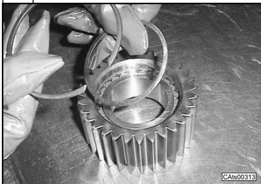
Montare l'altra ralla di rasamento e l'anello d'arresto nella sede del satellite epicicloidale.
