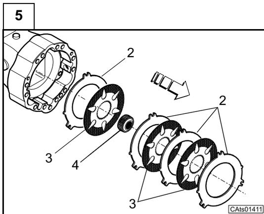
Sfilare dalla tromba trave tutti i componenti del freno: dischi (3), controdischi (2) e mozzo traino dischi freno (4).
