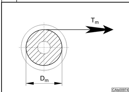
Il precarico totale  $T_m$  è misurato sull'attrezzo CA715520 (diametro calibrato  $D_m = 125$  mm).
