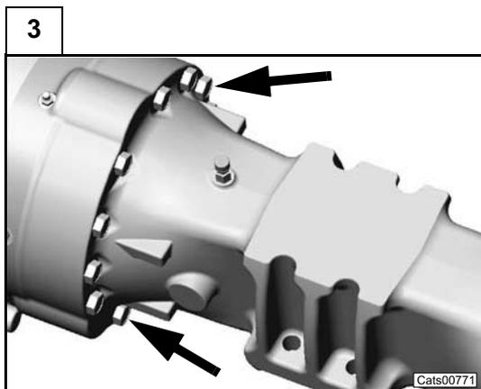
Svitare le viti di fissaggio per smontare la tromba trave.
