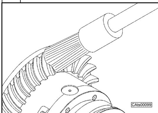
**Nota:** Per verificare l'impronta di contatto dei denti della coppia conica, sporcare con minio la corona e rilevare il contatto.
